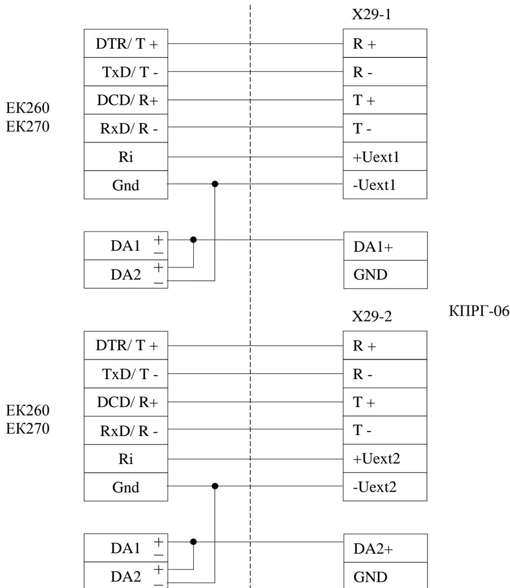
Рисунок 2 Схема подключения КПРГ-06 к корректору EK260/EK270
