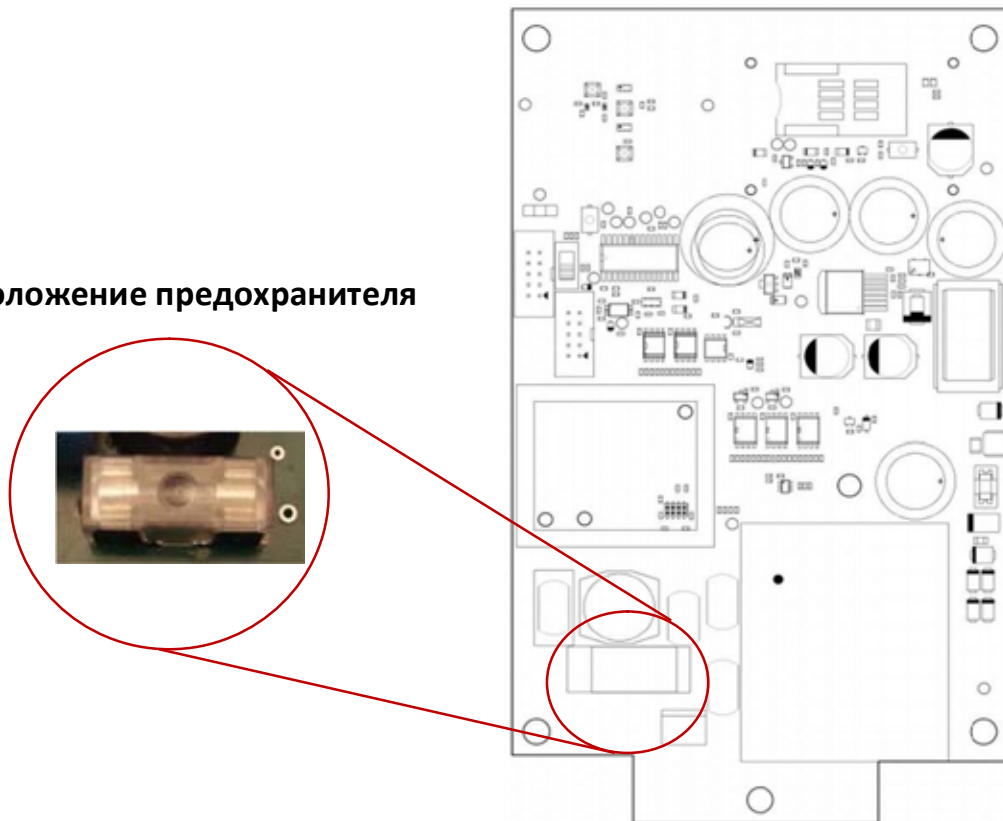
Рисунок 13. Расположение предохранителя в концентраторе
