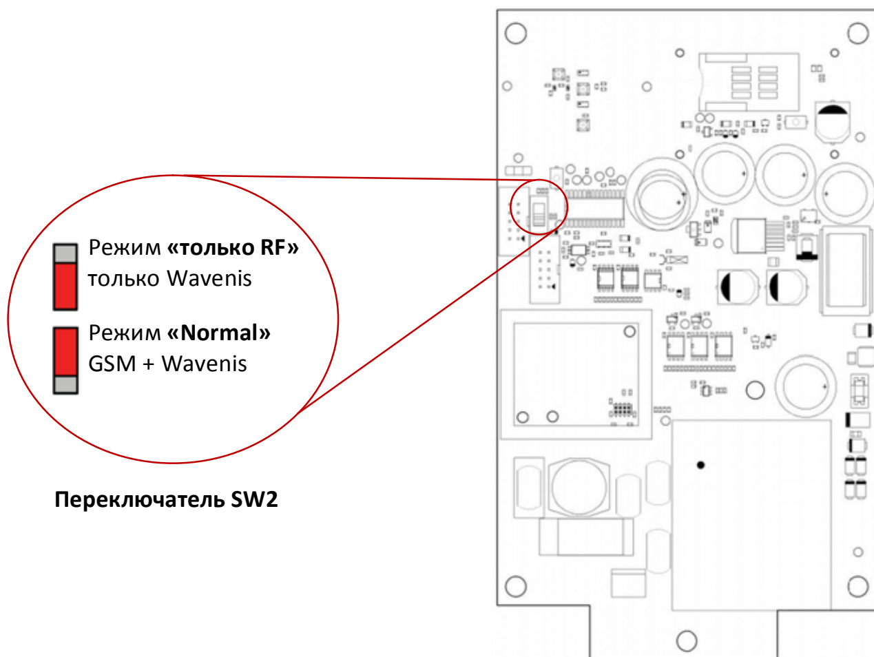
Рисунок 8. Переключение режимов работы концентратора
