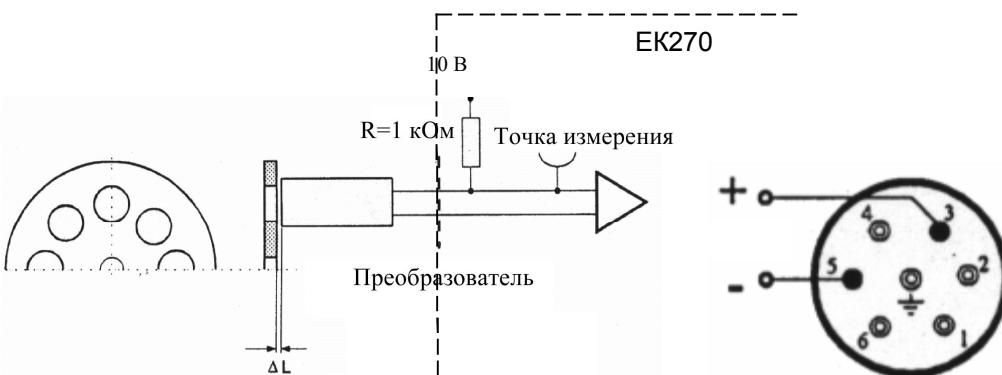
Разъём Binder (вилка) расположен на корпусе датчика A1R.
