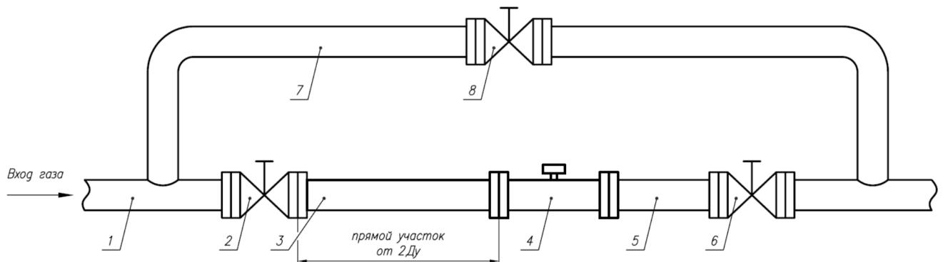
Рисунок Е.1 – Монтаж счетчика без перепускного канала
