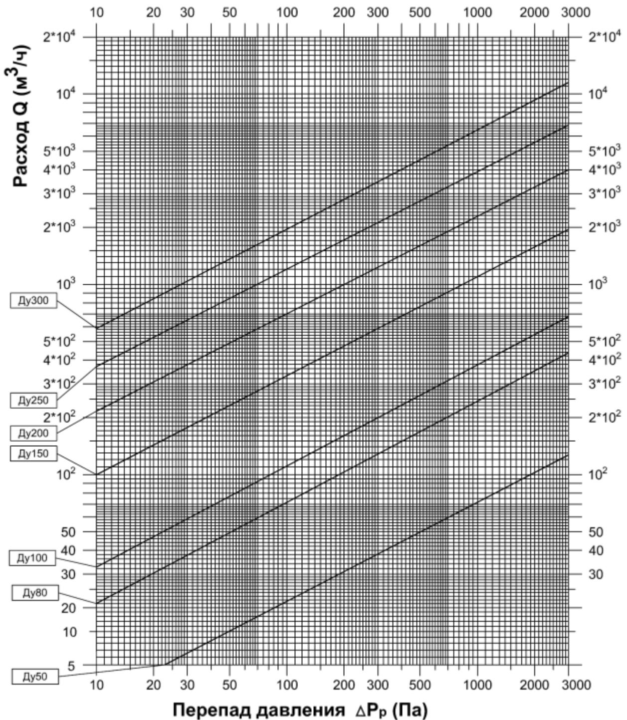
Рисунок А.1 - Зависимость перепада давления на счётчиках газа с различными диаметрами условного прохода от расхода газа. График приведен для газа с плотность  $\rho=1,29$   $\text{кг}/\text{м}^3$  при давлении, близком к атмосферному.
